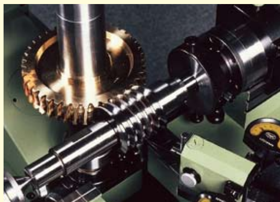
KLINGELNBERG 公司制造的蜗杆蜗轮啮合检测仪
