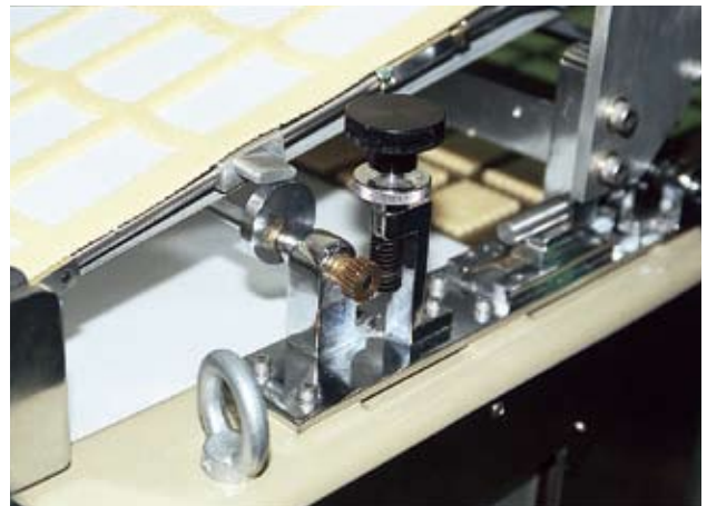
使用 SW 蜗杆和 BG 蜗轮调整输送布料的高度
