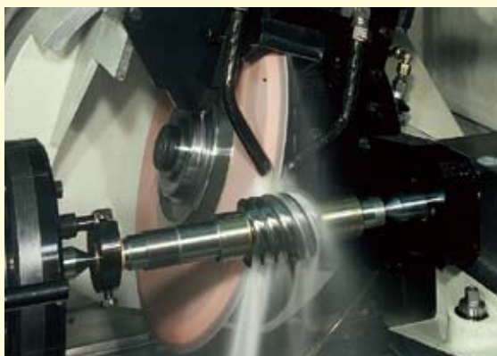
KLINGELNBERG 公司制造的蜗杆磨削机
